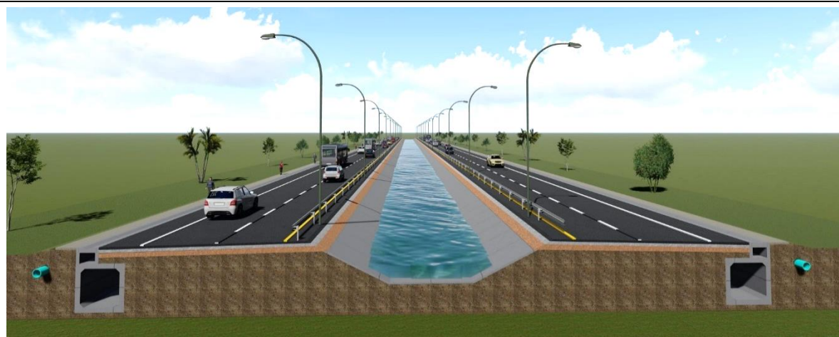
รูปที่ 4 ภาพตัดรูปแบบทางเลือกที่ 3 เกาะกลางแบบกดเป็นร่อง (Depressed Median)
