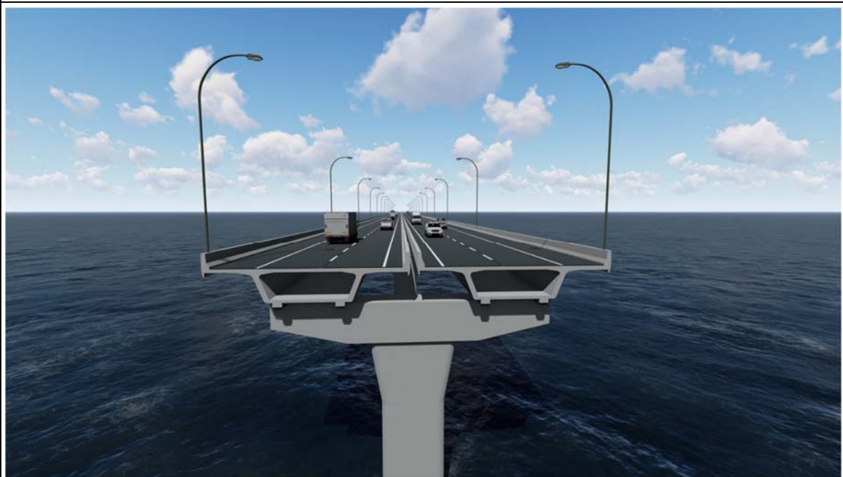
รูปที่ 4 ภาพตัดรูปแบบสะพานข้ามแม่น้ำตาปี
